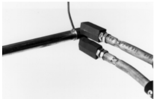
Figura 7 – Soldadura con las puntas de carbono sólo en contacto con el fitting
